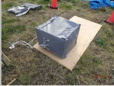
写真-3 BOXヒータによる加熱
