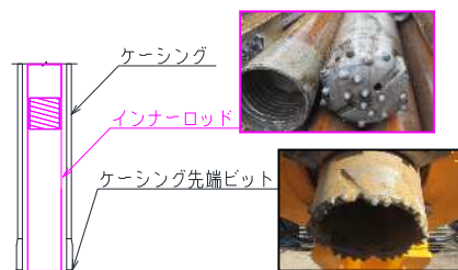
図-9 削孔方法と使用機材
