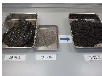
改質効果（即時改質→左側の泥が添加混合直後に右側の土状に改質）
