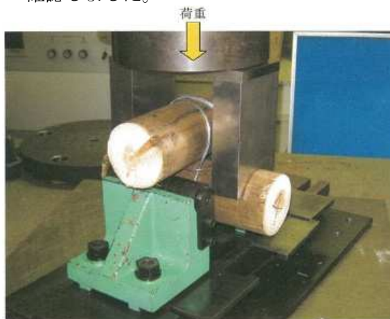
写真 - 5 ①鉄線(二重縄掛け)固定
