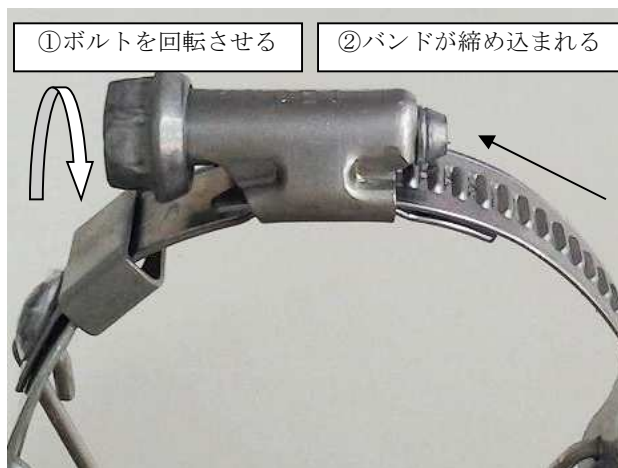
写真-2 ボルトを回転させて締め込む構造
