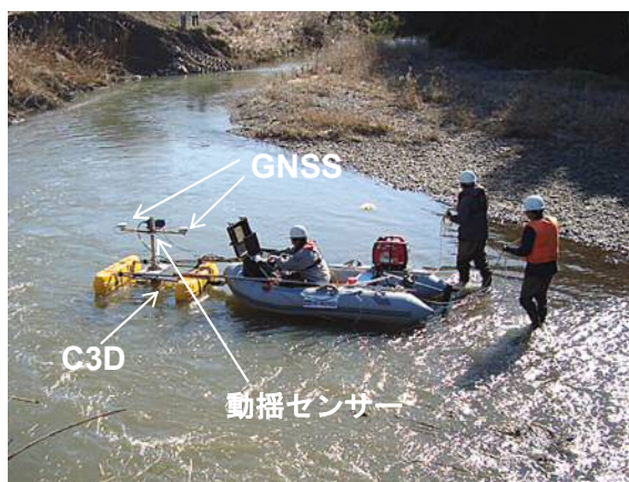
写真1：C3Dによる極浅水域の河川における測深状況
