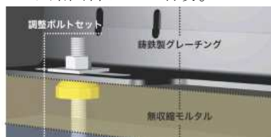
図④ 調整ボルトセットでの ミリ単位での高さ調整
