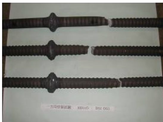
写真-1 一方向引張試験 (SD345、D51)
