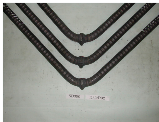
写真-2 曲げ試験 (SD390、D32)
