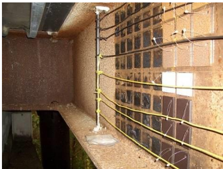
暴露試験片の状況
