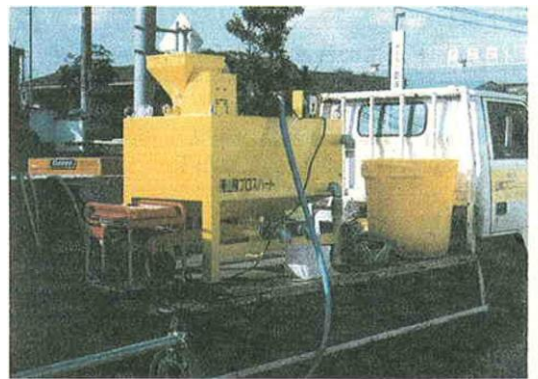
写真. 2 市成污水枝線その6工事 ネオナイトクリーナー 3 t/h 処理型
