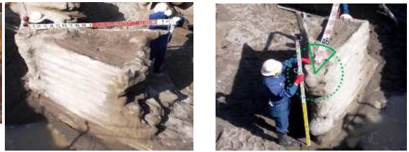
図-3 野外造成実験(改良体形状 噴射揺動角度45°)
