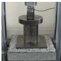
写真-1 剥がれ負荷試験状況
