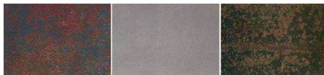
錆原板 1種ケレン 3種ケレン
