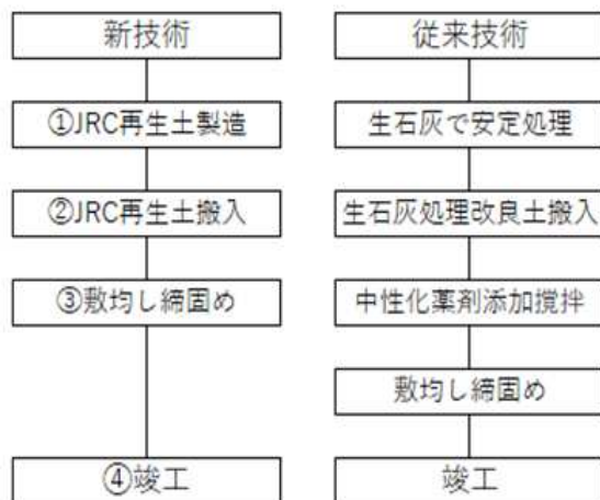
図-1 新技術と従来技術の施工フロー
