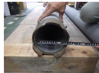
アタッチメント刃先部 (内径 125 φ 外径 150 φ)
