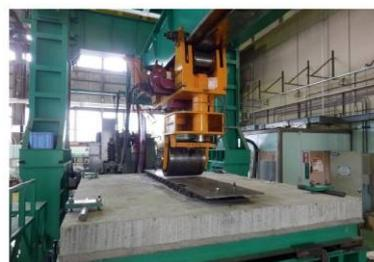
写真-4 輪荷重走行試験
