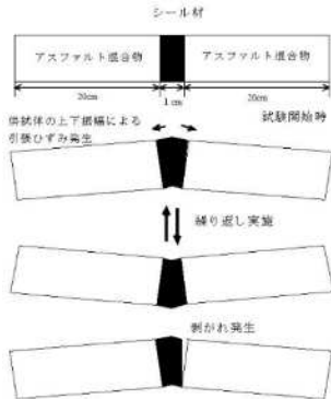
図-5 剥がれ抵抗性試験の概念図
