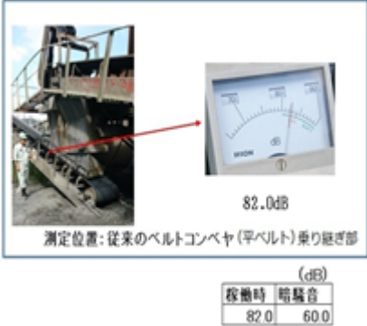
写真-2 従来技術と新技術 (実証機) の騒音測定
