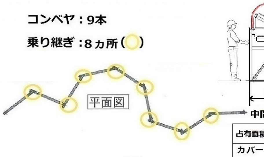
図-6 全長1.4kmベルトコンベヤ概要図（従来技術）
