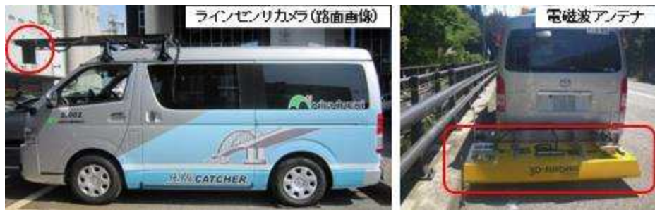
写真-1 床版キャッチャー外観と測定状況
