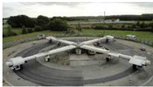
写真3：フルスケール輪荷重試験機
