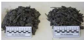
写真8：左グラスグリッドなしアスコンガラ
