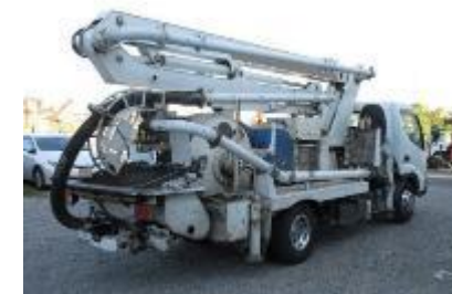
コンクリートポンプ車
