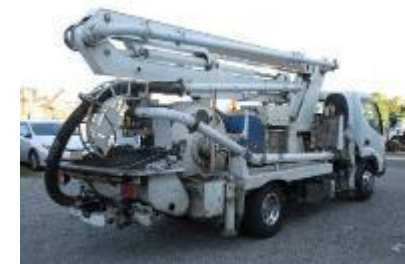
コンクリートポンプ車
