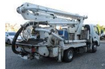
コンクリートポンプ車
