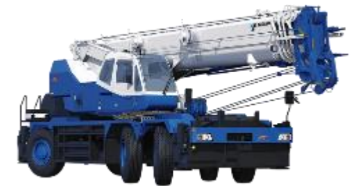
25 t ラフテレーンクレーン
