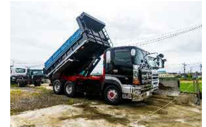
ダンプトラック(10t,4t,2t) (河川土工)
