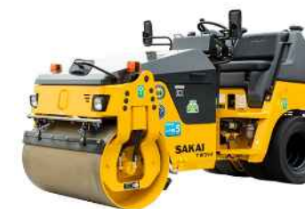
コンバインドローラー (河川土工、舗装工)
