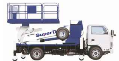
高所作業車 (アクリル防水壁設置工)
