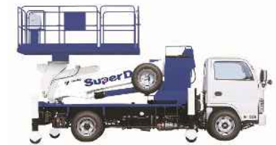
高所作業車 (剪定工)
