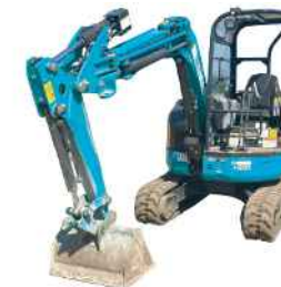
ミニバックホウ (河川土工)
