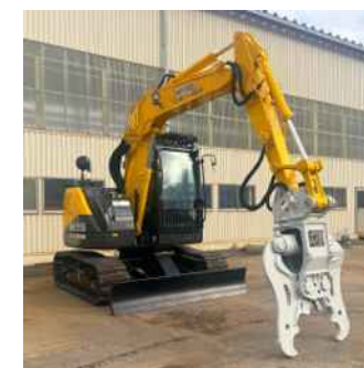
クラッシャー (既設護岸取り壊し)
