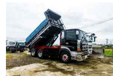
ダンプトラック(10t, 4t, 2t) (河川土工)
