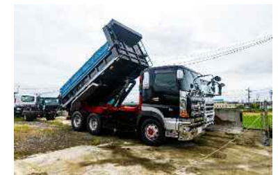
ダンプトラック(10t,4t,2t) (河川土工)
