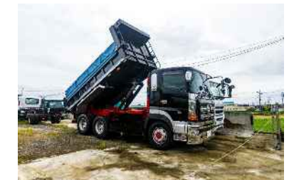
ダンプトラック(10t,4t,2t) (河川土工)
