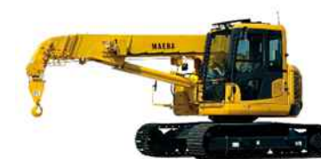
クローラークレーン (場所打杭建込)
