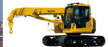
クローラークレーン (大型土のう設置)
