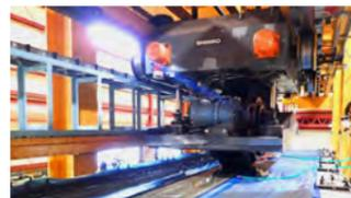
輪荷重走行試験機による疲労試験
