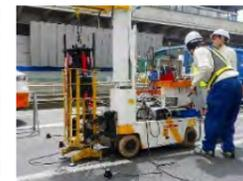
実橋測定（重錘落下試験）
