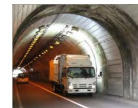
走行型画像計測車を活用した壁面画像計測
