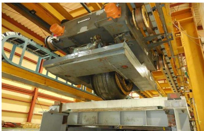
【輪荷重走行疲労試験機（戸田橋実験場）】
