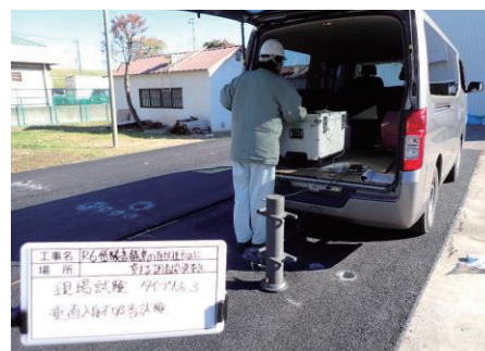
写真－2 吸音率試験（令和 6 年度現場試験）
