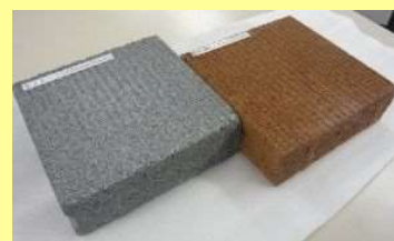
透水性ブロック例（噛み合わせ式）
