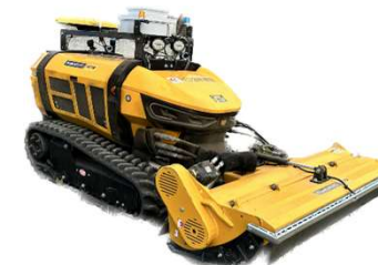
※R5年度に受注者の自社持ち遠隔除草機で急傾斜地を施工
