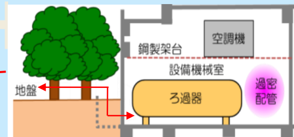
ろ過器の交換に樹木の撤去及び地盤の掘削が必要
