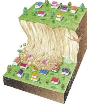
③ 急傾斜地の崩壊 (がけ崩れ)
