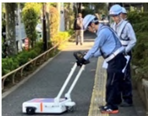
図 10-4 地中レーダー探査の実施状況
