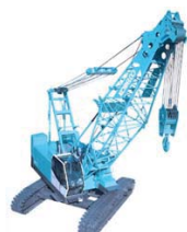
(70t吊りクレーン)
