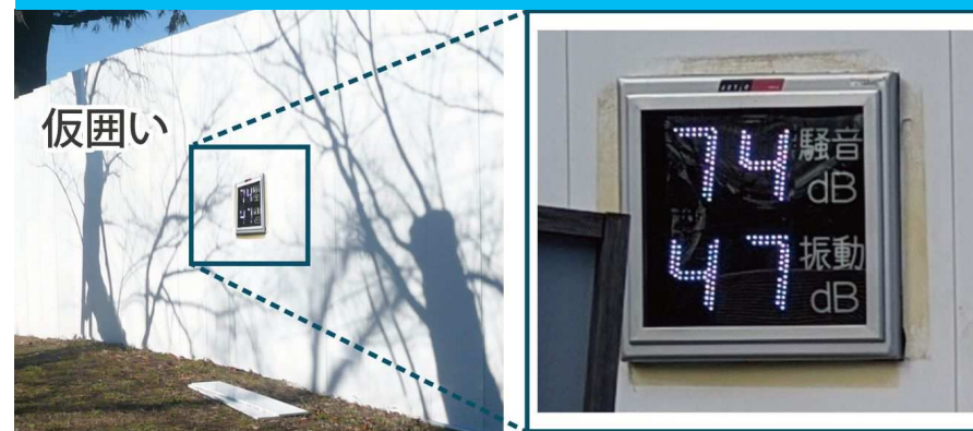
リアルタイム計測値の表示状況
