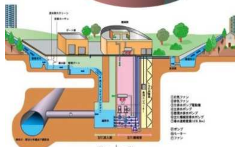
トンネル式(神田川・環七地下調節池) 2007年度完成
