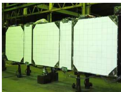
図-9 実大連結エレメント曲げ試験（左：状況、右：結果）
