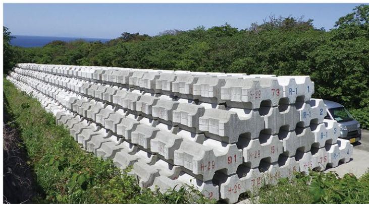
仮設堰堤の材料となるブロック備蓄状況(三宅島)
