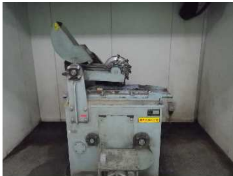
写真-6. 1 ラベリング試験機
