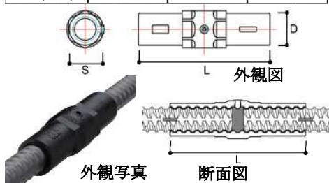
【図-1】在来型ねじ節鉄筋用機械式継手の外観図・断面図・外観写真
