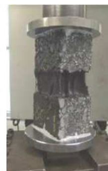
新技術は変位量が10mmを超えても破断せず 写真-3 引張試験状況
