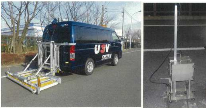
写真－1 車載型レーダーと孔内カメラ
