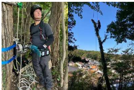
作業者に高い集中力が求められるツリークライミング 伐採で電動ウインチを使用した様子
