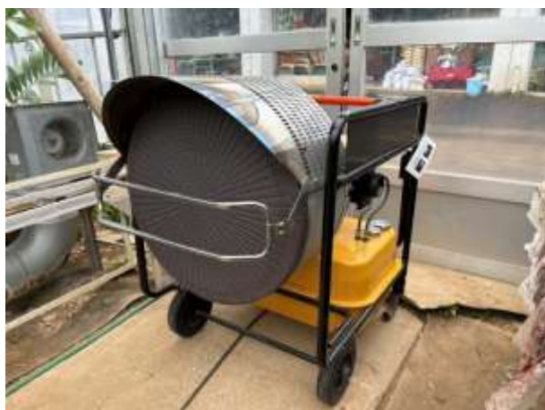
写真 19 栽培温室 A 温水管漏水 のため臨時加温設置
