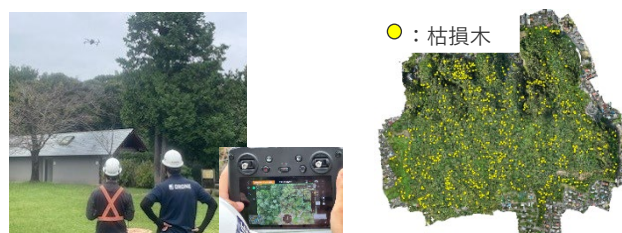
撮影したデジタルオルソ画像を解析した結果、上図の黄色の箇所に990本の枯損木発生が見られることが判明した
