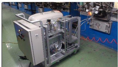
非常用オイルバーナー
