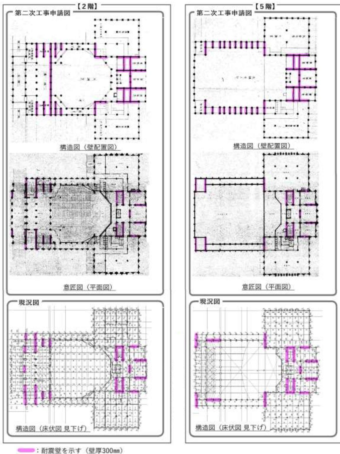
図5-26 壁配置の比較 (2階、5階の例)
