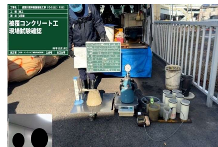
【生コン現場試験（全体）】
