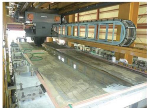
写真-2 輪荷重走行装置(水張試験)
