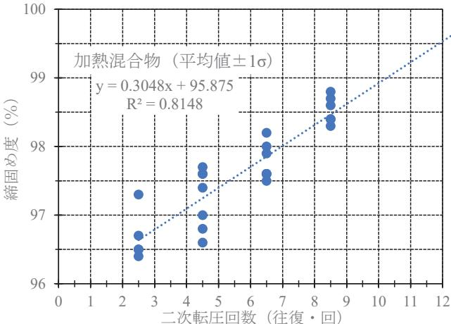
図-4 二次転圧回数と締固め度の関係
