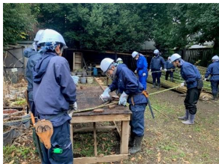
竹に熱を加えて曲げる研修の様子
