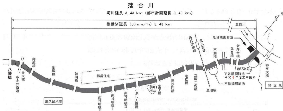
昭和44年に黒目川合流点から一級河川終点まで3.43kmの都市計画決定後、事業に着手した。下流黒目川の改修工事との関連で当初は用地取得を先行させていたが、昭和47年度から黒目川の改修規模に整合させて暫定改修（時間雨量30ミリ対応）を進めてきた。黒目川同様、昭和57年度に黒目川合流点から時間雨量50ミリ規模の護岸改修工事に着手し、平成22年度に護岸の整備が完成した。
