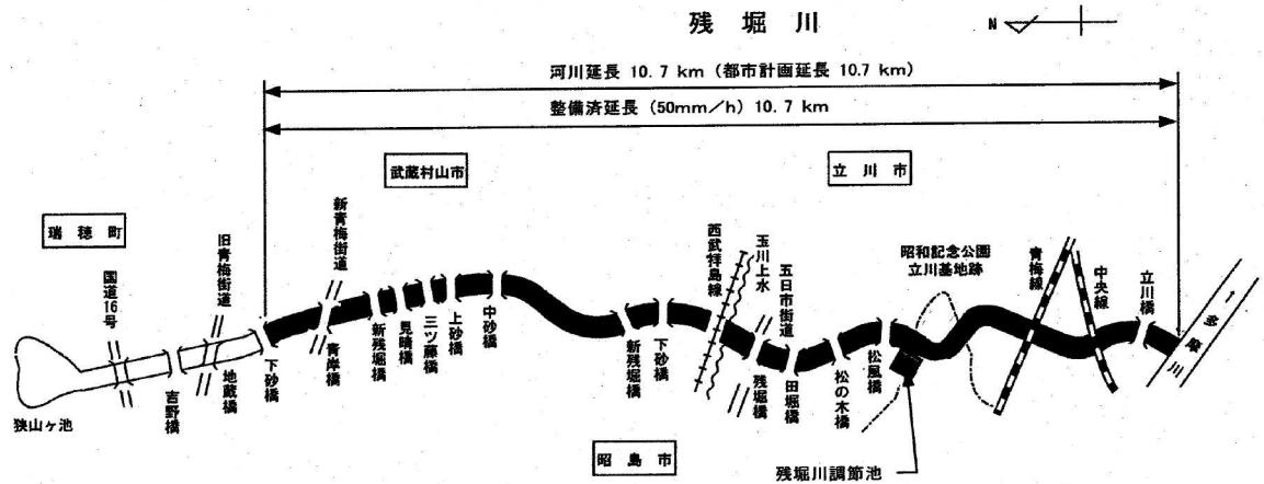
流域の大部分は立川段丘に属し、地形も比較的平坦であり、河道は立川ローム層に掘込河道を形成しながら流下しているが、段丘の端部で約10mの落差を形成している。
