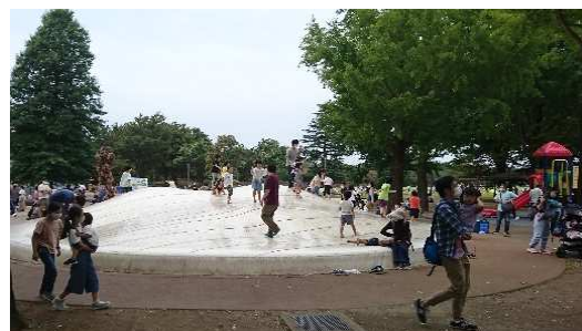
ふわふわドーム 空気膜構造の遊具で、飛んだり跳ねたり、揺れたりして遊べる。縁を高くして移乗しやすくしている。
