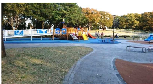
広場内の舗装 園路はアスファルト系舗装。遊具周りはゴムチップ舗装で、安全領域は必要に応じた厚さとなっている。
