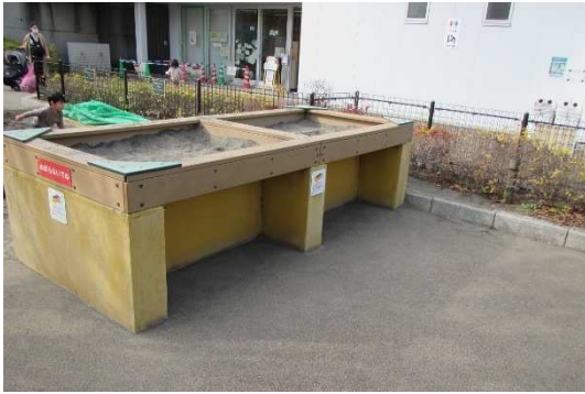
写真1 レイズド砂場(1) 車いすでも楽しめるようになっている。高めのテーブルは保護者等にも利用しやすい。 (世田谷区立二子玉川公園)
