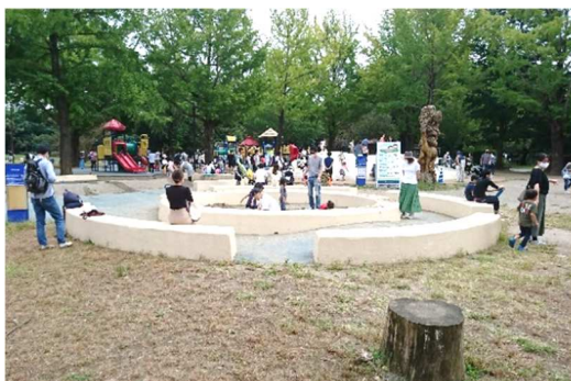
写真1 砂場（1） 「落葉のプール」として整備された施設。土いじり、砂いじりの場として利用されている。囲い周辺の通路の高さを変えることで、利用をしやすいようにしている。（国営昭和記念公園）
