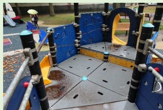
写真1 移乗用プラットフォーム トランスファーステーション、移乗用デッキなどと呼ばれることもある。(中央区立築地川公園)
