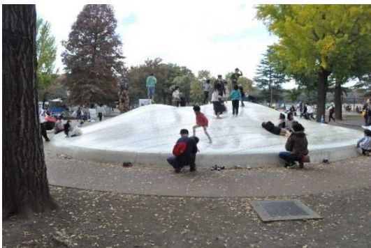
写真1 空気膜遊具 跳ねたり、揺れたり、寝転んで揺れを楽しんで遊ぶ。外周部を一段高くして車いすから移乗しやすくしている。(国営昭和記念公園)
