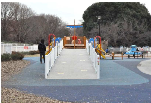
写真5 幅の広いスロープの複合遊具 車いすがすれ違える幅が確保されている。パネル等で遊んでいても人や車いすが通れる広さである。(都立砧公園)
