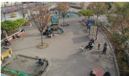
写真 1 全面ゴムチップ舗装の事例 園路は設けず、ゴムチップの広場内に遊具を配置している。（世田谷区立二子玉川公園）
