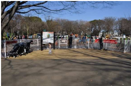
写真1 外周の囲いのある広場出入口（1） 小学生でも開閉できる門扉をつけ、常時は閉めた状態で管理 案内板を設置 舗装材も変えている。（都立砧公園）
