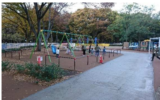
写真1 ブランコ設置面の舗装 安全領域全域にゴムチップ舗装（都立砧公園）
