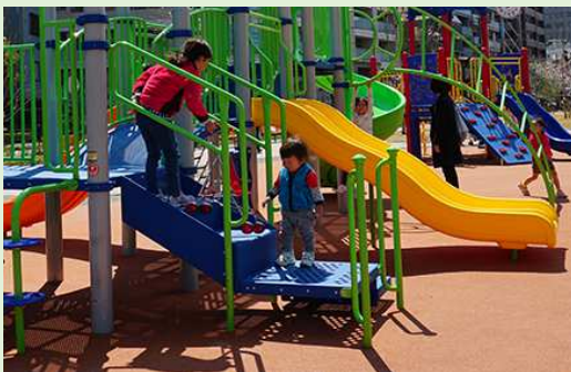
写真1 移乗用プラットフォーム トランスファーステーション、移乗用デッキなどと呼ばれることもある。(中央区立築地川公園)
